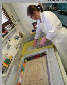
Priprava zmesi tehničnega kamna in cementa
