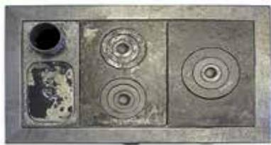
V Pokrajinskem muzeju Maribor smo leta 2015 odkupili enega izmed Tobijevih v prvi seriji (med letoma 1948 do 1950) izdelanih zeleno emajliranih štedilnikov na trda goriva, tip 201, s kotličem za vodo. Dotrajana notranjost, korozjski propad materiala, poškodovana in delno preurejena zunanjost so narekovali kompleksen pristop k stabilizaciji celote.
