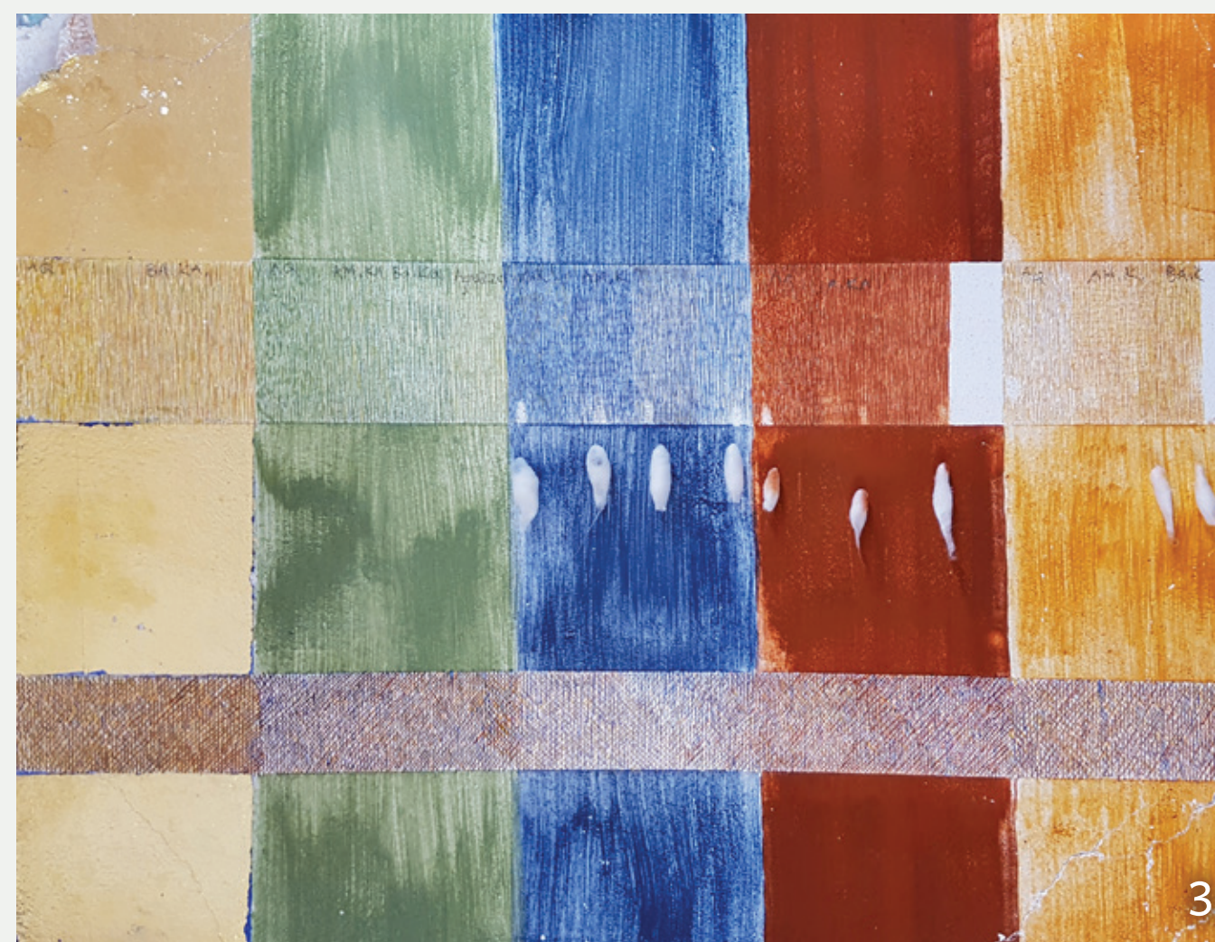
Slika 3, 4: Vajenica z izvedbo retuše v barvni selekciji in barvni abstrakciji z različnimi vezivi. (foto Ajda Mladenović)
