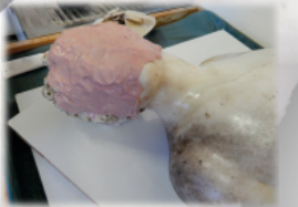
Izdelava kalupa s silikonskim kavčukom Realizzazione dello stampo in gomma silicica
