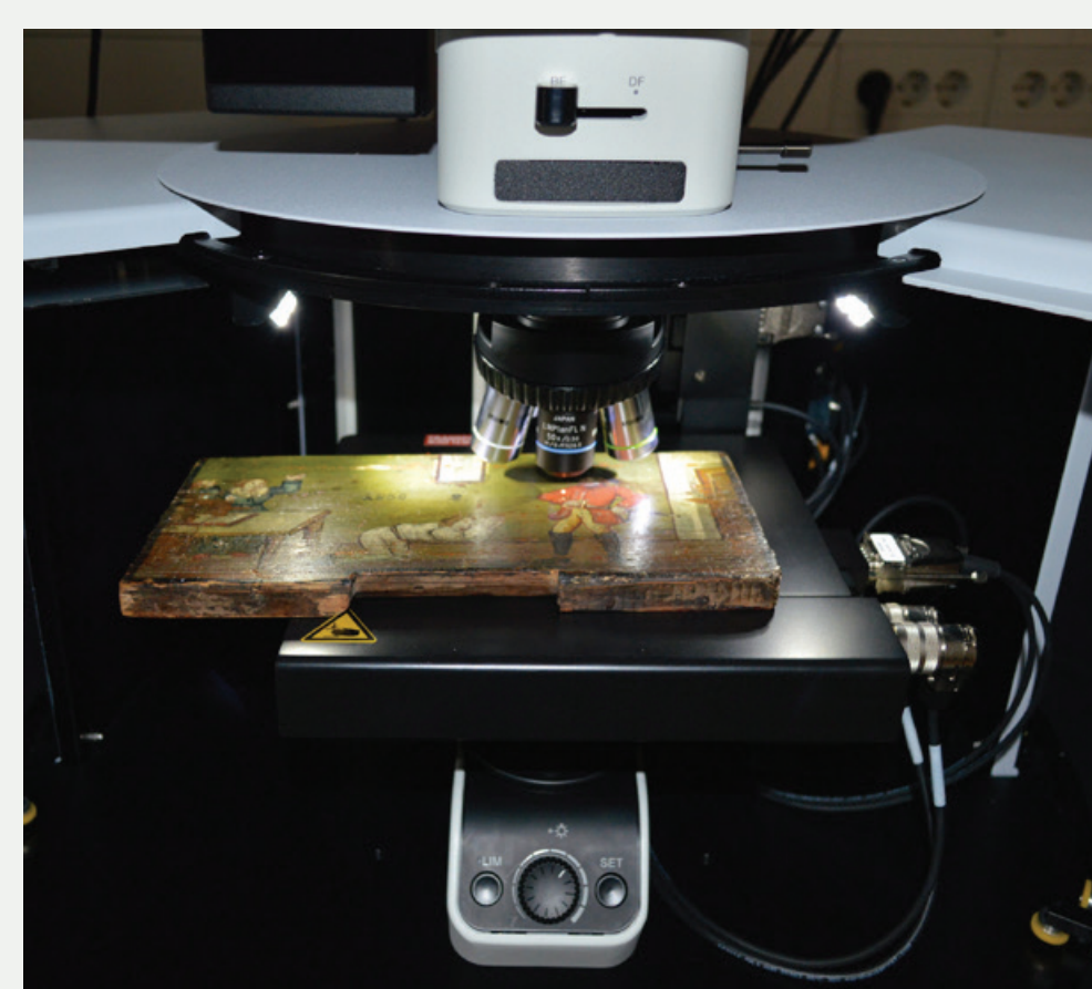
Slika 4: Med neinvazivno analizo PK1 s stacionarnim FT-ramanskim spektrometrom MultiRAM (Bruker). (Foto: Maša Kavčič)
