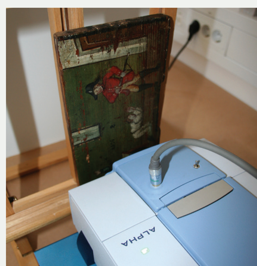
Slika 3: Med neinvazivno analizo PK1 s prenosnim FTIR-spektrometrom Alpha-R (Bruker). (Foto: Maša Kavčič)
