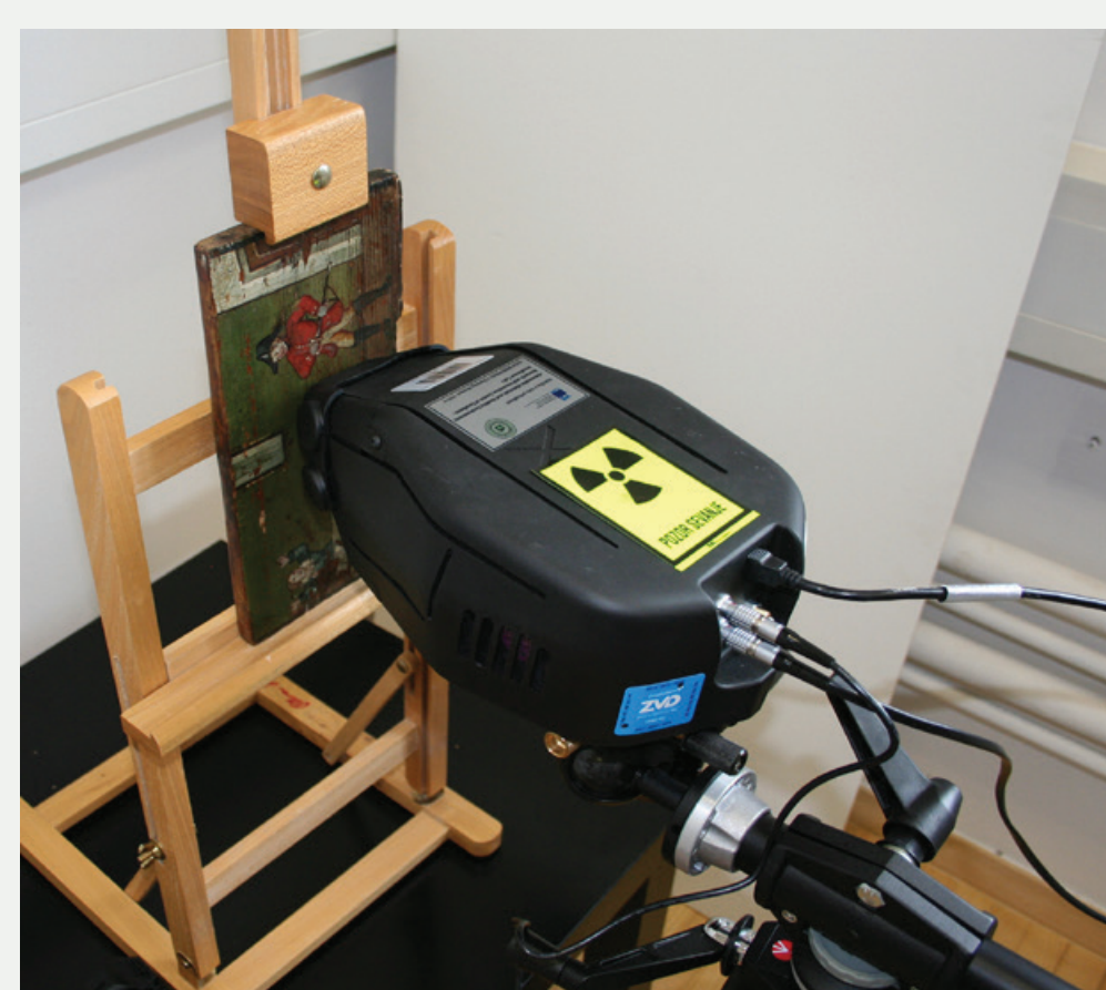
Slika 2: Med neinvazivno analizo PK1 s prenosnim XRF-spektrometrom Elio (Bruker). (Foto: Maša Kavčič)
