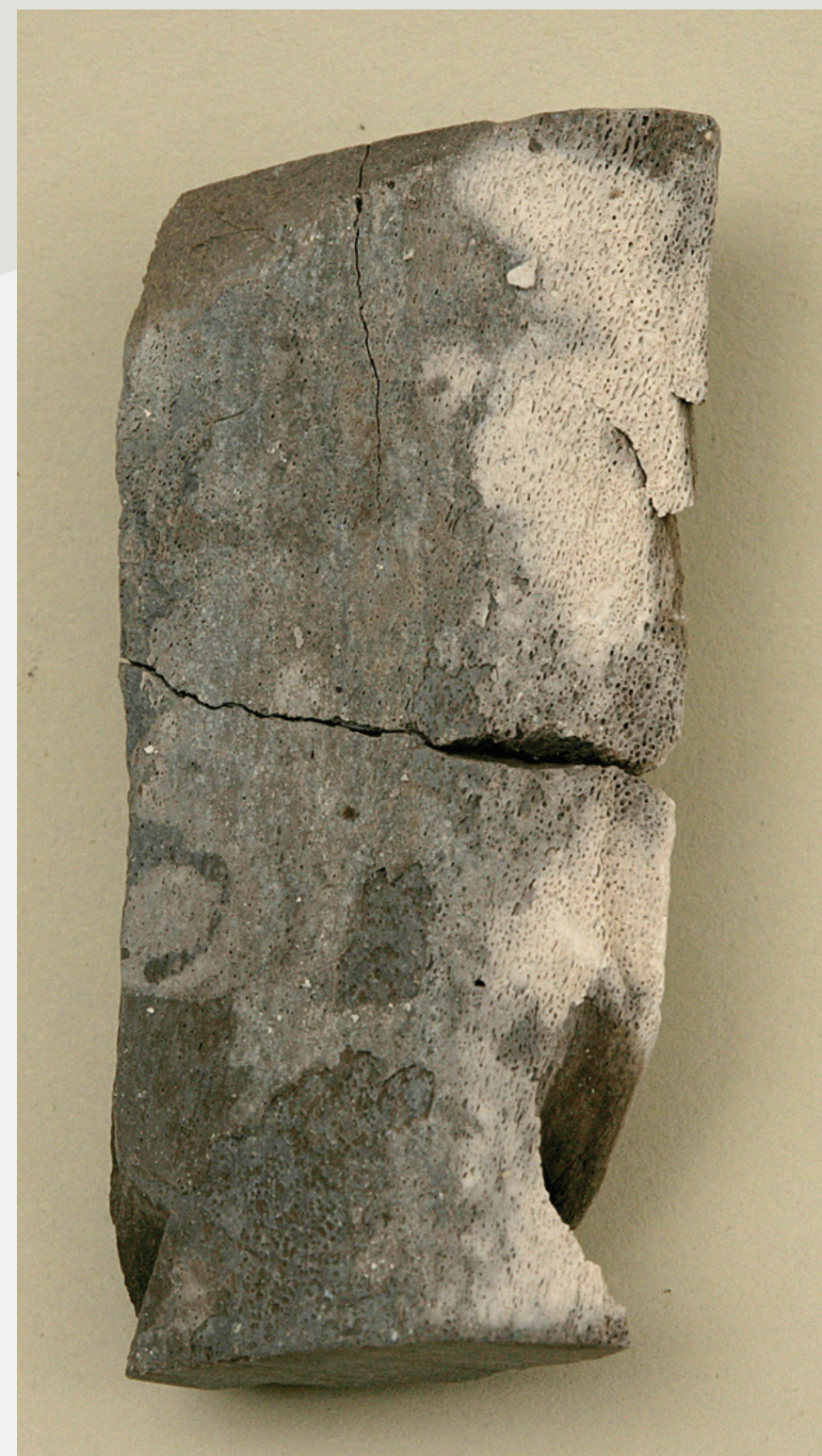
Slika 1: Modelni vzorec žgane goveje kosti žgane na 600°C za 120 min. (foto: Lea Legan)
