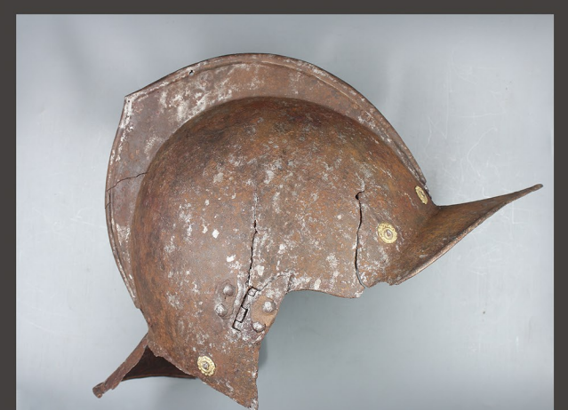
Detajl peskane površine in čelada po peskanju
