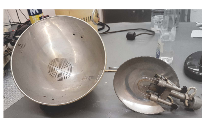
Razstavljanje pokrova in žarnice v obliki črke U
