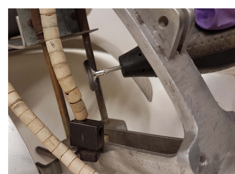
Odstranjevanje korozije z mikromotorjem
