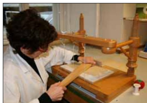
Šivanje leg na tri enojne konopljene vezice s pulpo
