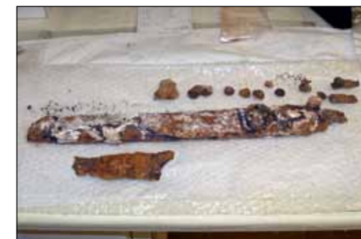
Meč po izvedbi alkalno sulfitnega postopka
