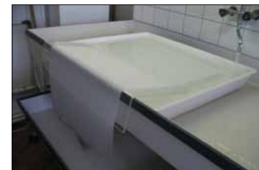
Priprava na mokro čiščenje s pomočjo kapilarnega vleka (foto: Meta Kojc)
