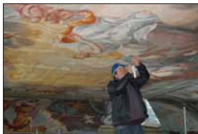
Nameščanje brezžičnega merilnika s senzorjem za merjenje temperature površine
