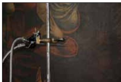
Spremljanje sondiranja z IR spektrometrom
