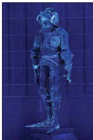
Preiskava površine z ultravijolično fluorescenco (foto: Andrej Hirci)
