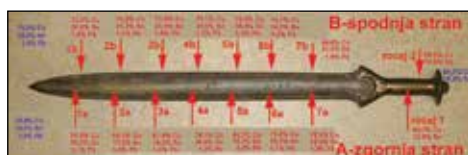
Meč V655 z analiznimi mesti in rezultati analiz
