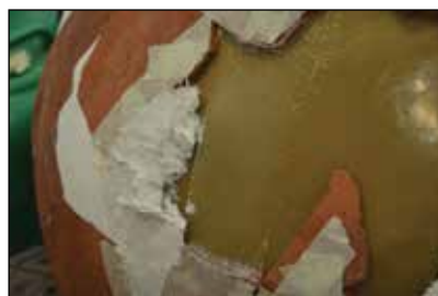
Mavec z rezanimi steklenimi vlakni
