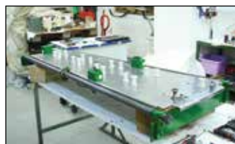
Zduževalna miza med sestavljanjem
