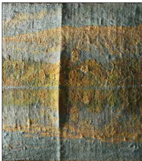
Detajl deformacije platnena nosilca ob šivu, osvetljenega s stransko svetlobo pod kotom 0°, pred posegom.
