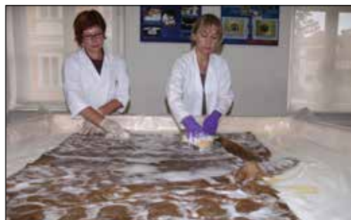
Pranje pelerine v prirejenem bazenu z deionizirano vodo in anionsko aktivnim pralnim sredstvom
