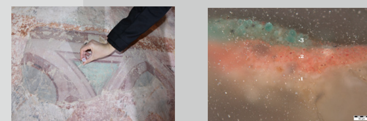
Slika 10: (a) Lokacija vzorca z Aquilove poslikave arhitekturnega elementa na severni steni prezbitერიja; (b) stratigrafija vzorca. Preko rdeče barvne plasti, ki vsebuje rdeči oker, je nanesena zelena barvna plast malahita.
