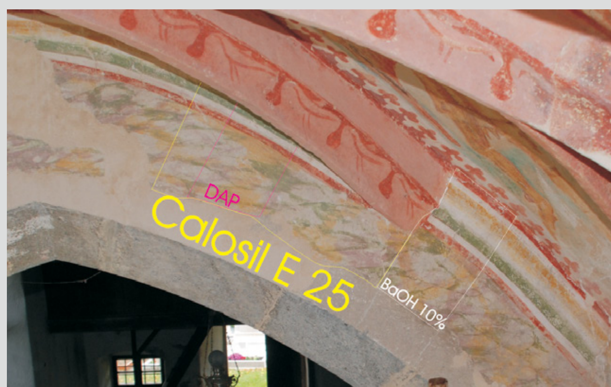
Sliki 6a, 6b: Poskusno utrjevanje na slavočni steni z barijevim hidroksidom, di-amonijevim fosfatom in Calosilom (Cal 1). Potemnitev poslikave, ki jo je povzročil di-amonijev fosfat je izginila šele po dobrem letu.
