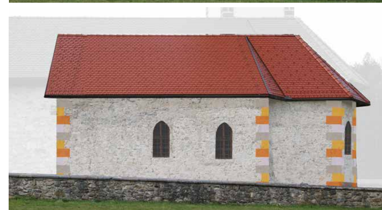
Digitalna rekonstrukcija gotške faze cerkve na osnovi pregleda fasad po odstranjanju ometov.
