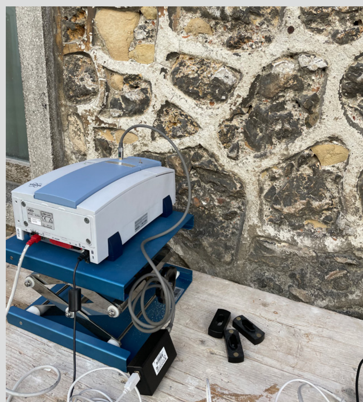
Slika 3: Meritve s prenosnim spektrometrom FTIR na stranski fasadi. (foto: Lea Legan)
