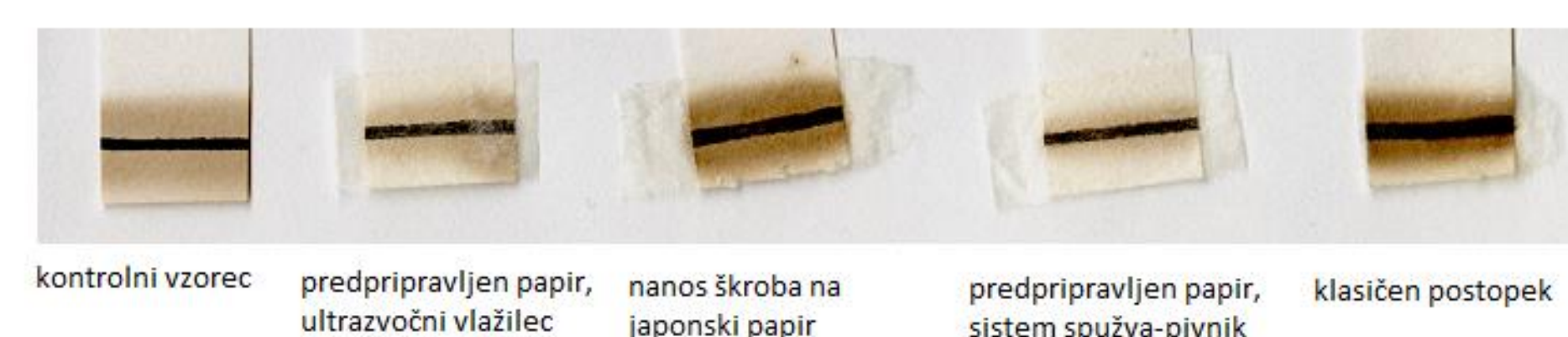
Slika 2: Vzorci papirja z železo-taninskim črnilom po različnih postopkih popravil in termičnim pospešenim staranjem (foto: Ksenija Janković).
