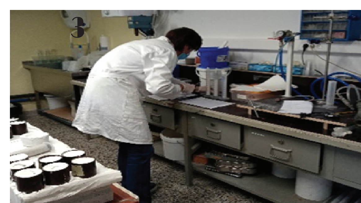
Slika 1: Apnene skodelice z injekcijsko maso.
