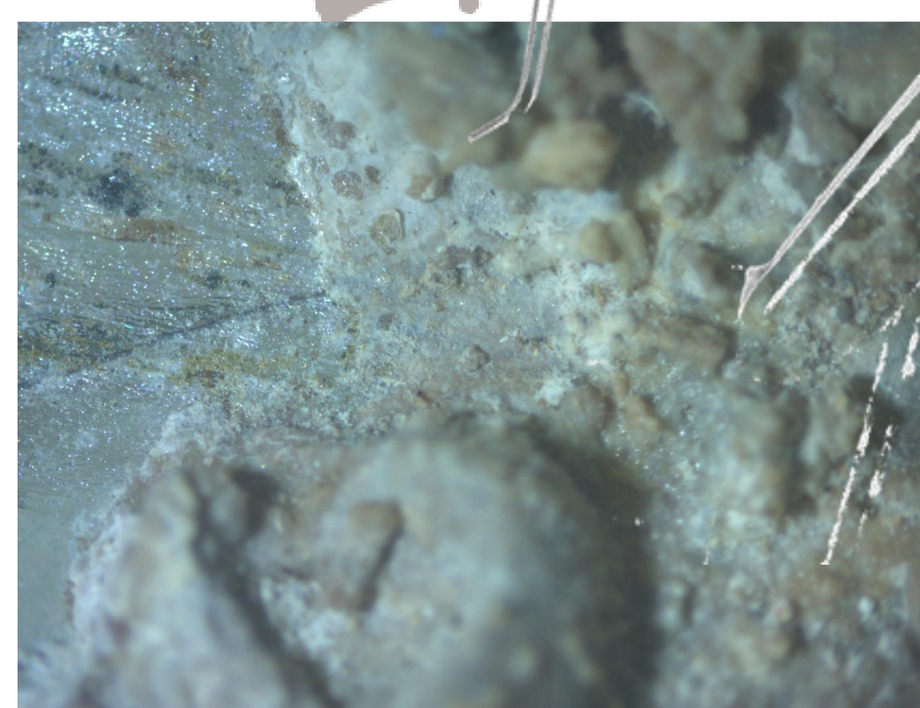
Slike 3,4 ter 5,6: Odstranjevanje kalcinacijske skorje z ultrazvočnim kladvcem pod mikroskopom (foto: Helena Pucelj Krajnc)
