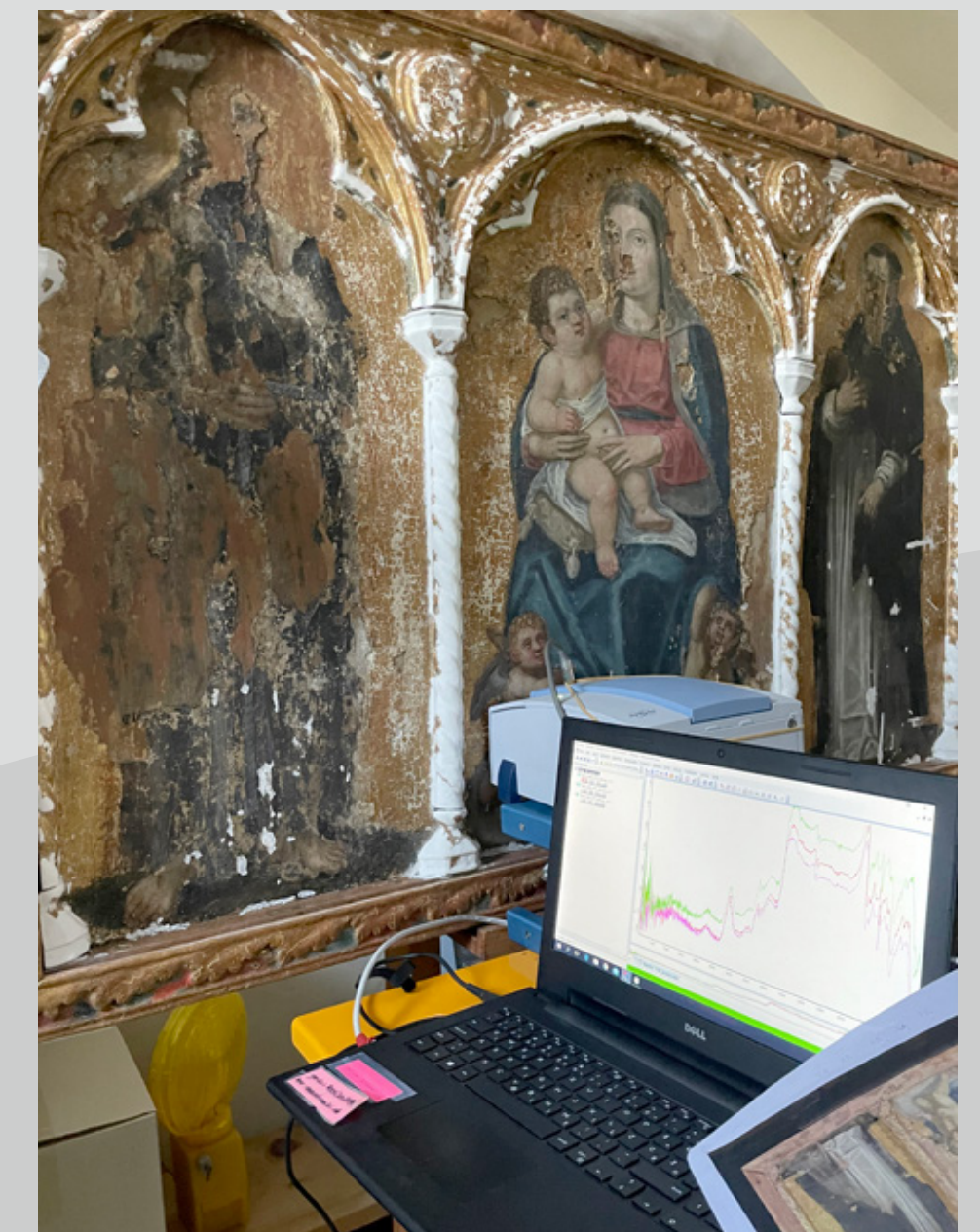
Slika 3: Preiskava s prenosnim infrardečim spektrometrom (Foto: Maša Kavčič).
