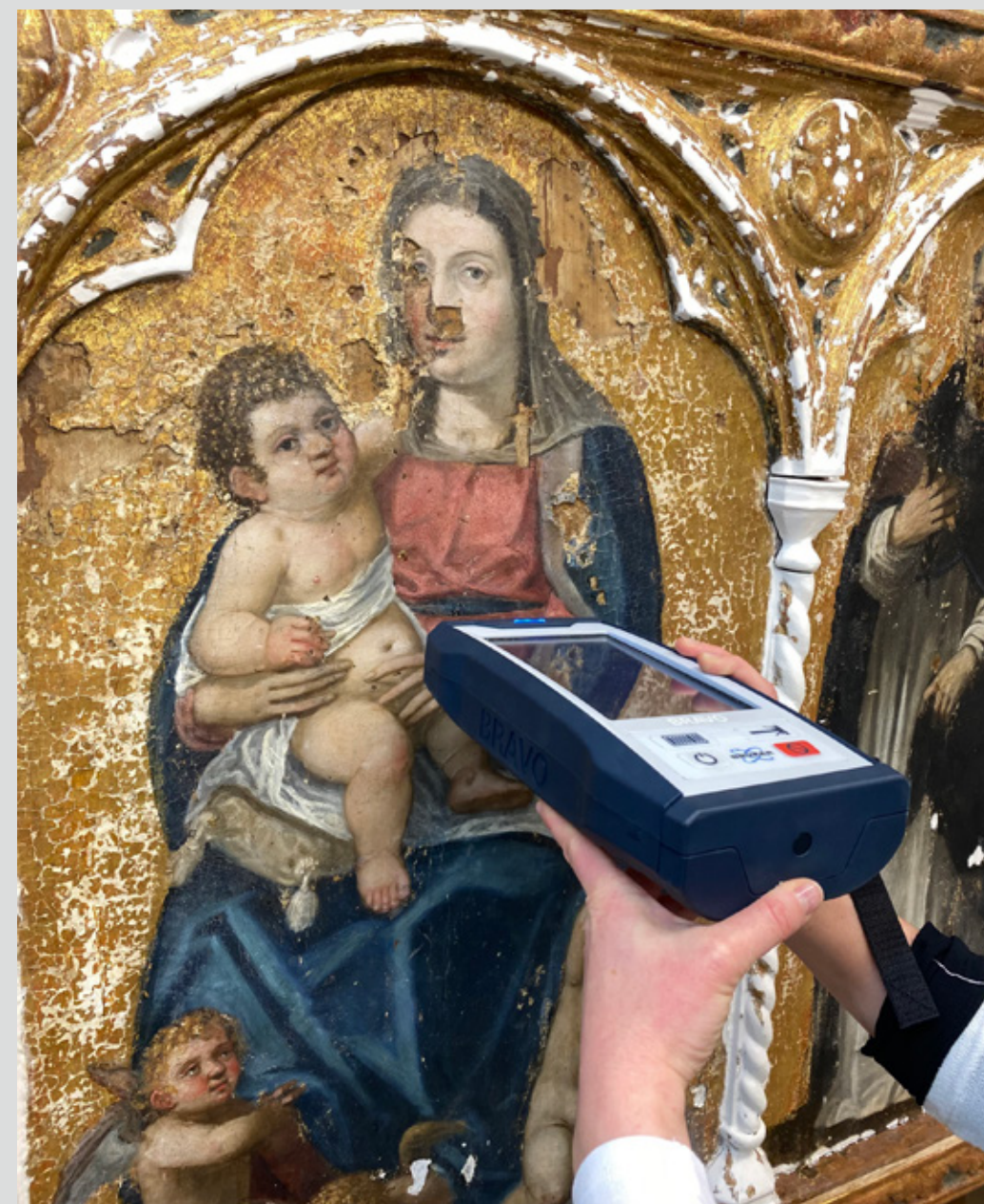
Slika 1: Preiskava s prenosnim ramanskim spektrometrom (Foto: Lea Legan)
