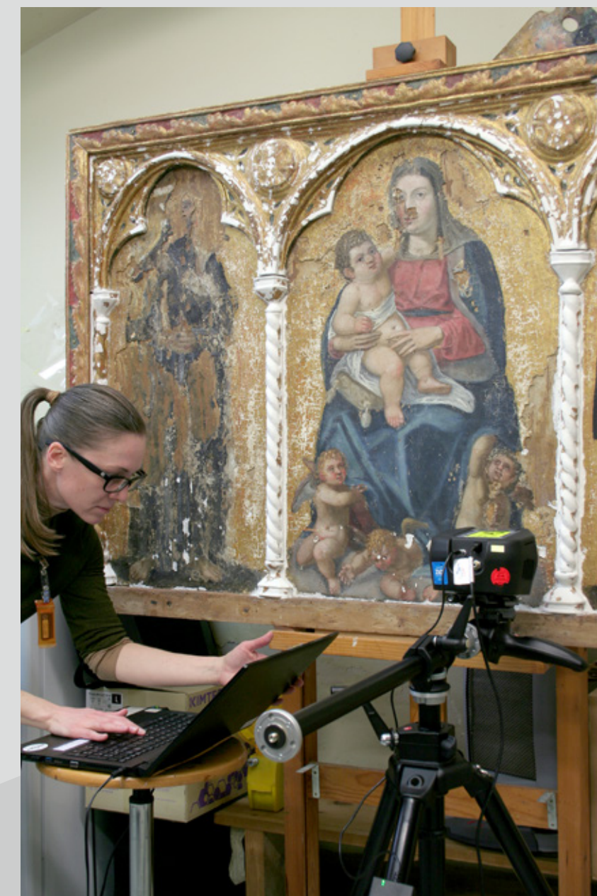
Slika 2: Preiskava s prenosnim XRF (Foto: Klara Retko)
