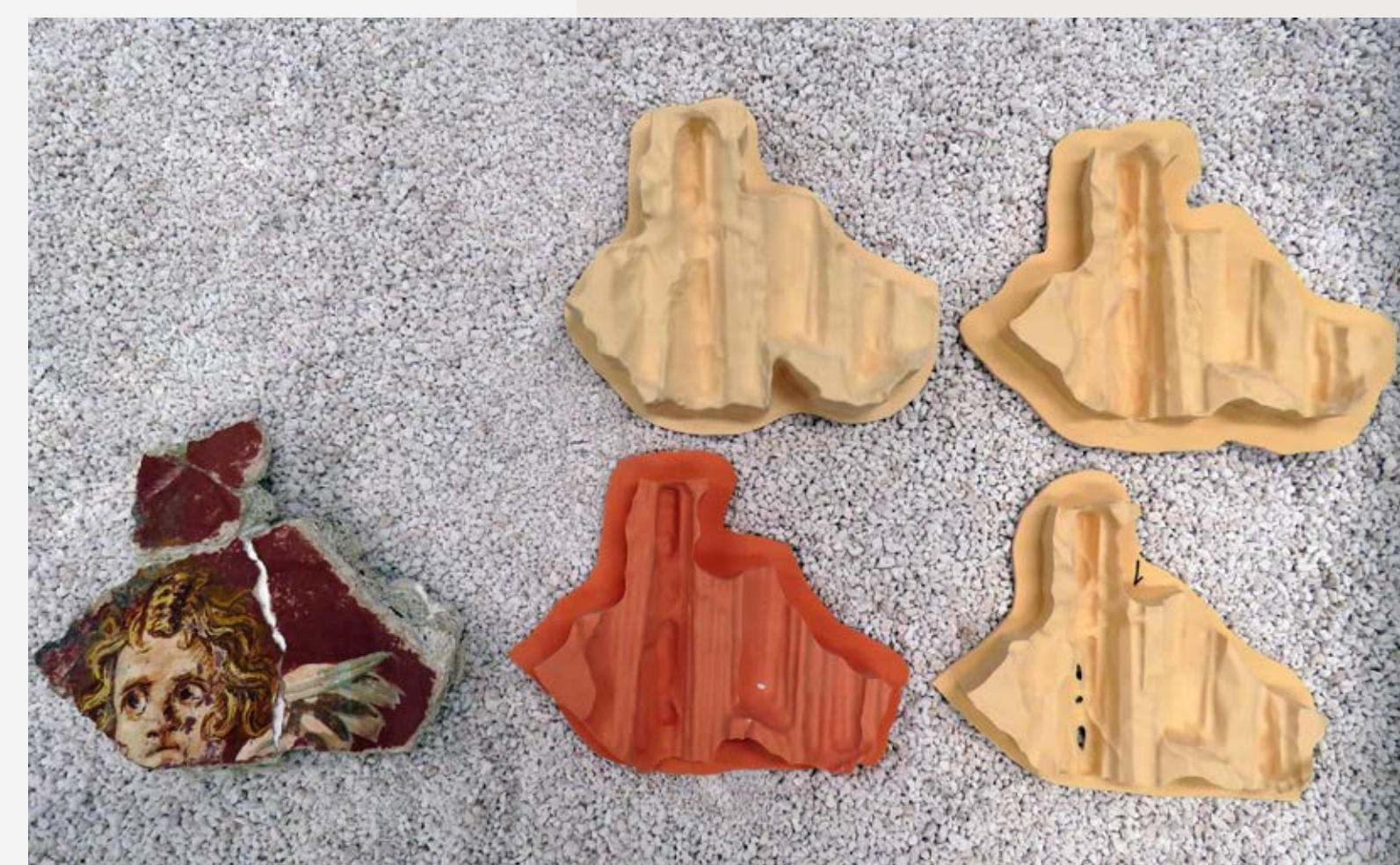
Slika 7: Podlage izrezkane z različnimi nastavitvami na CNC napravi (foto: Petra Benedik)
