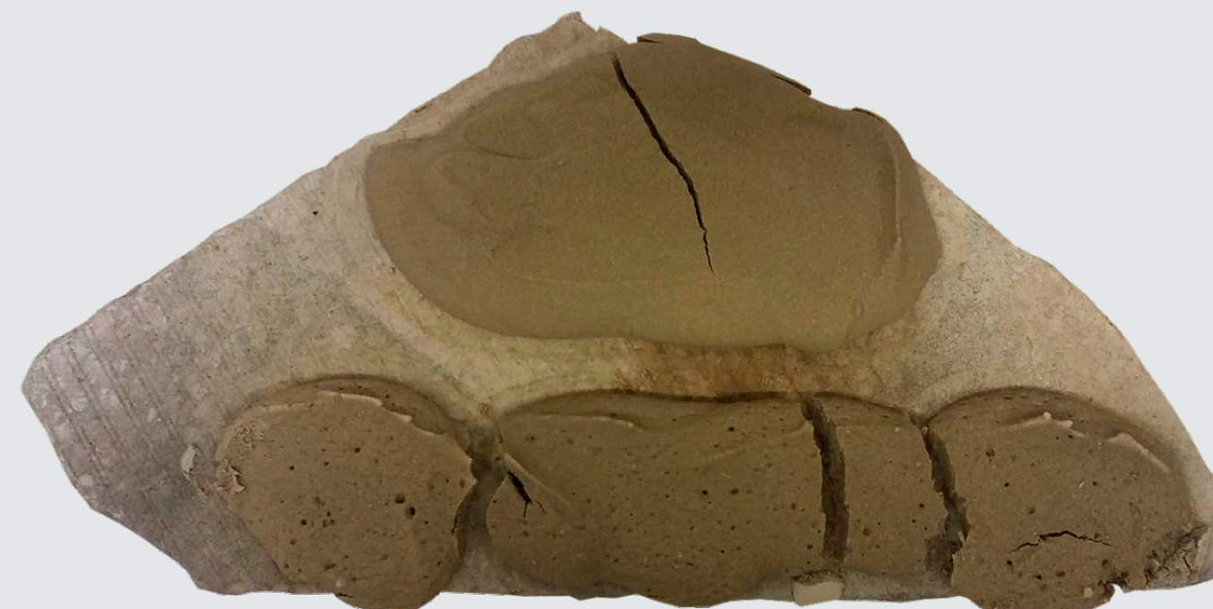
Faze sušenja vodne zmesi naravne gline sepiolit in sode bikarbone
