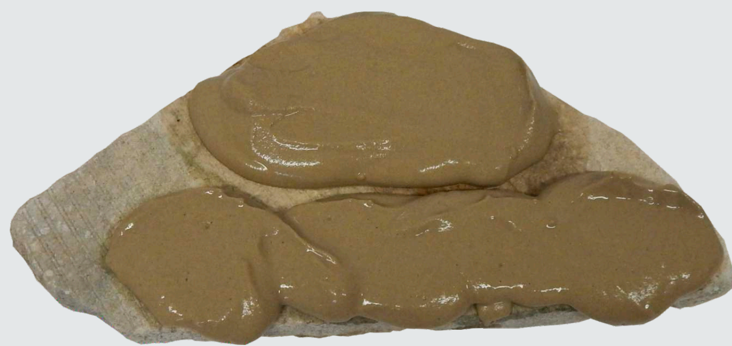
Faze sušenja vodne zmesi naravne gline sepiolit in sode bikarbone
