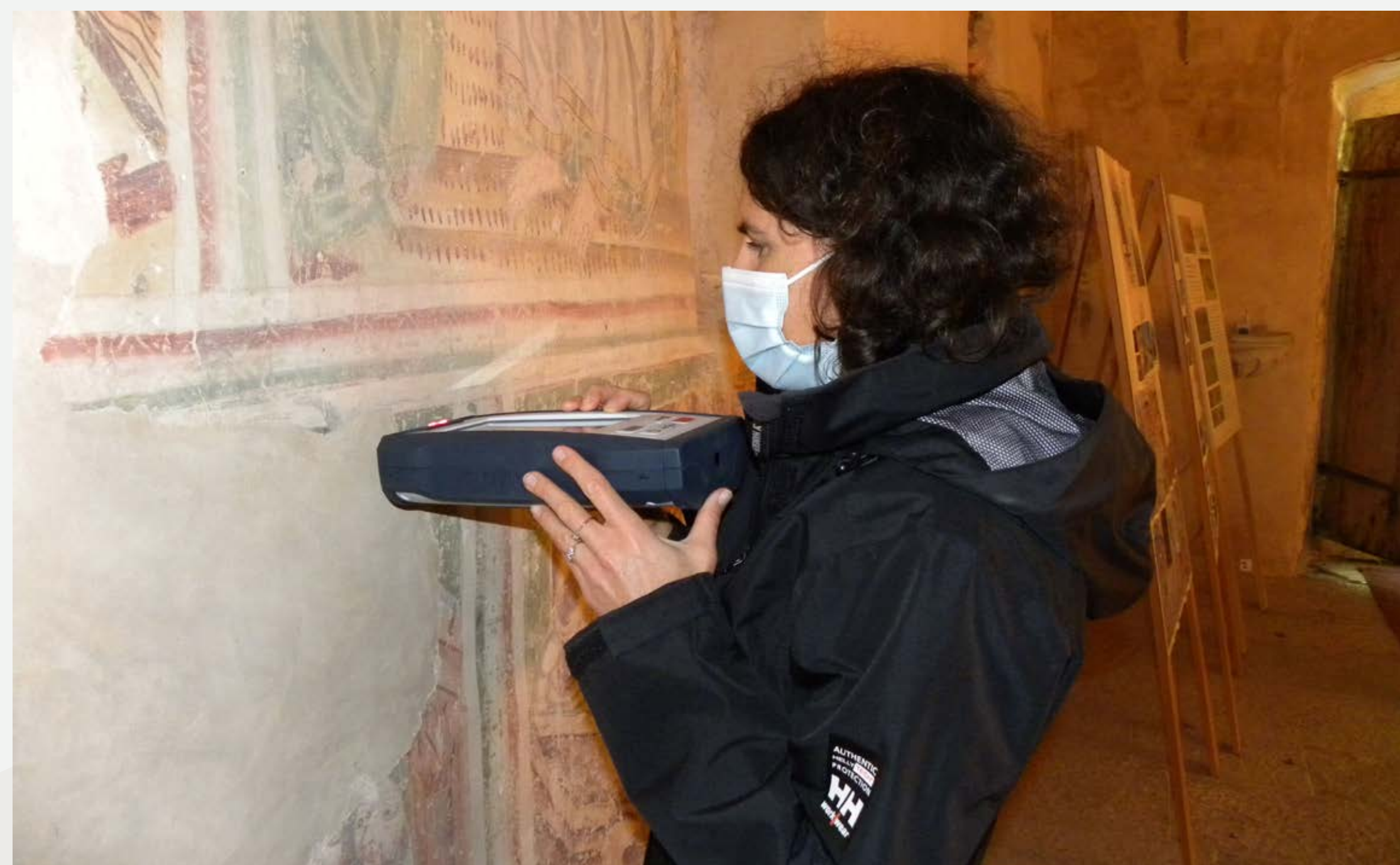
Slika 1: Izvajanje analiz s prenosnim ramanskim spektrometrom v p. c. sv. Helene (foto: M. Bensa).
