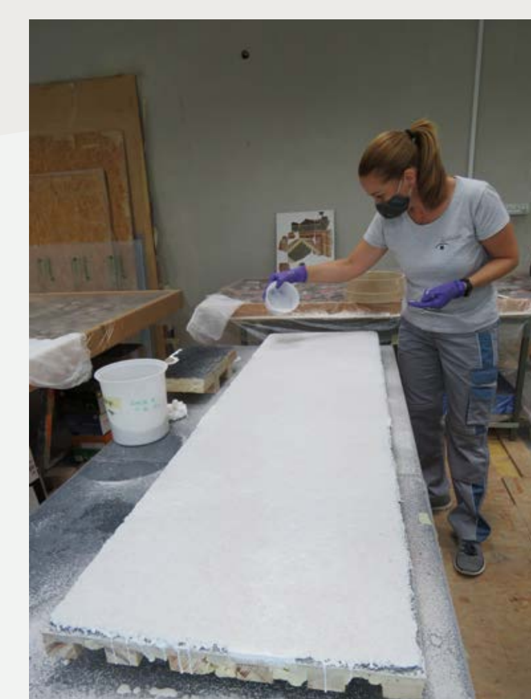
Slika 4: Izdelava apneno-kazeinske armature.
