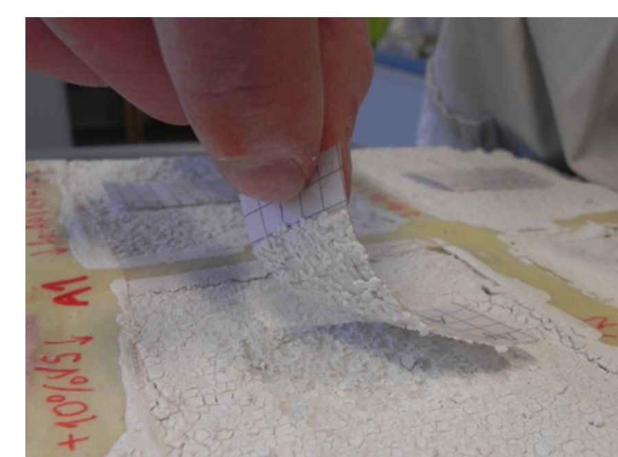
Kalijevo vodno steklo v premazih (N-VS2, N-VS10, AK-VS2, AK-VS2-OP, AP-VS2 in AP-VS10) vpliva na nastajanje razpok med sušenjem.
