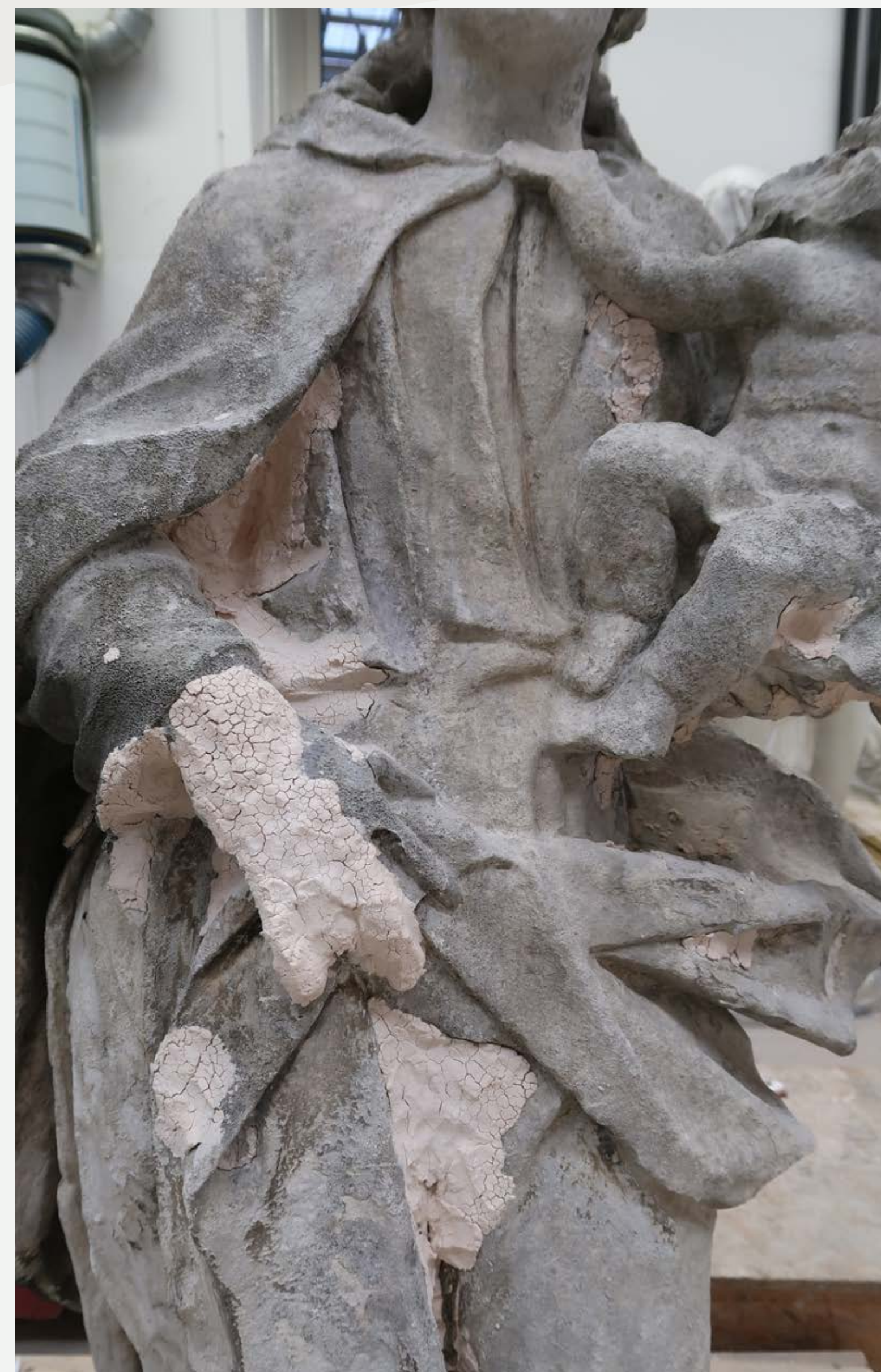
Slika 4: Strjevanje anionske smole (kip Marije iz Radelj ob Dravi, detajl desne roke), foto: arhiv ZVKDS RC
