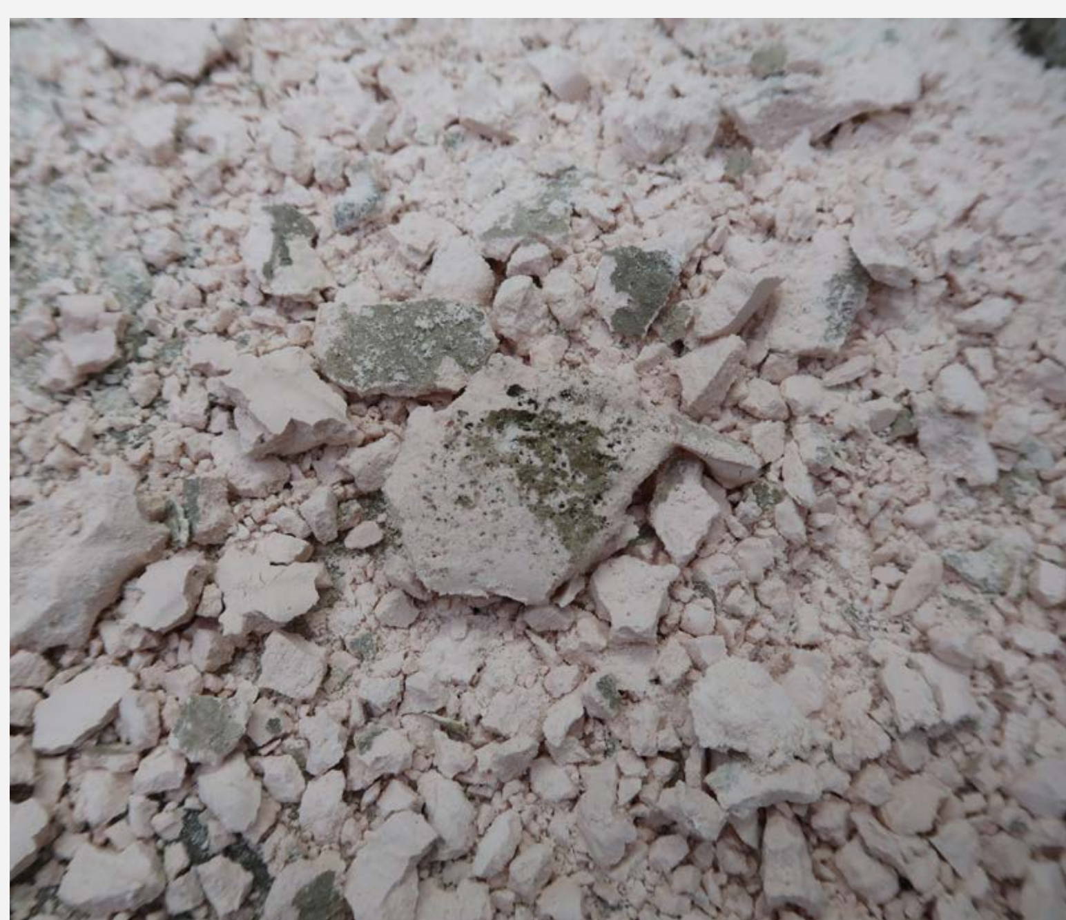
Slika 5: Anionska smola po odstranjevanju skorjaste obloge na kipu Marije, foto: arhiv ZVKDS RC
