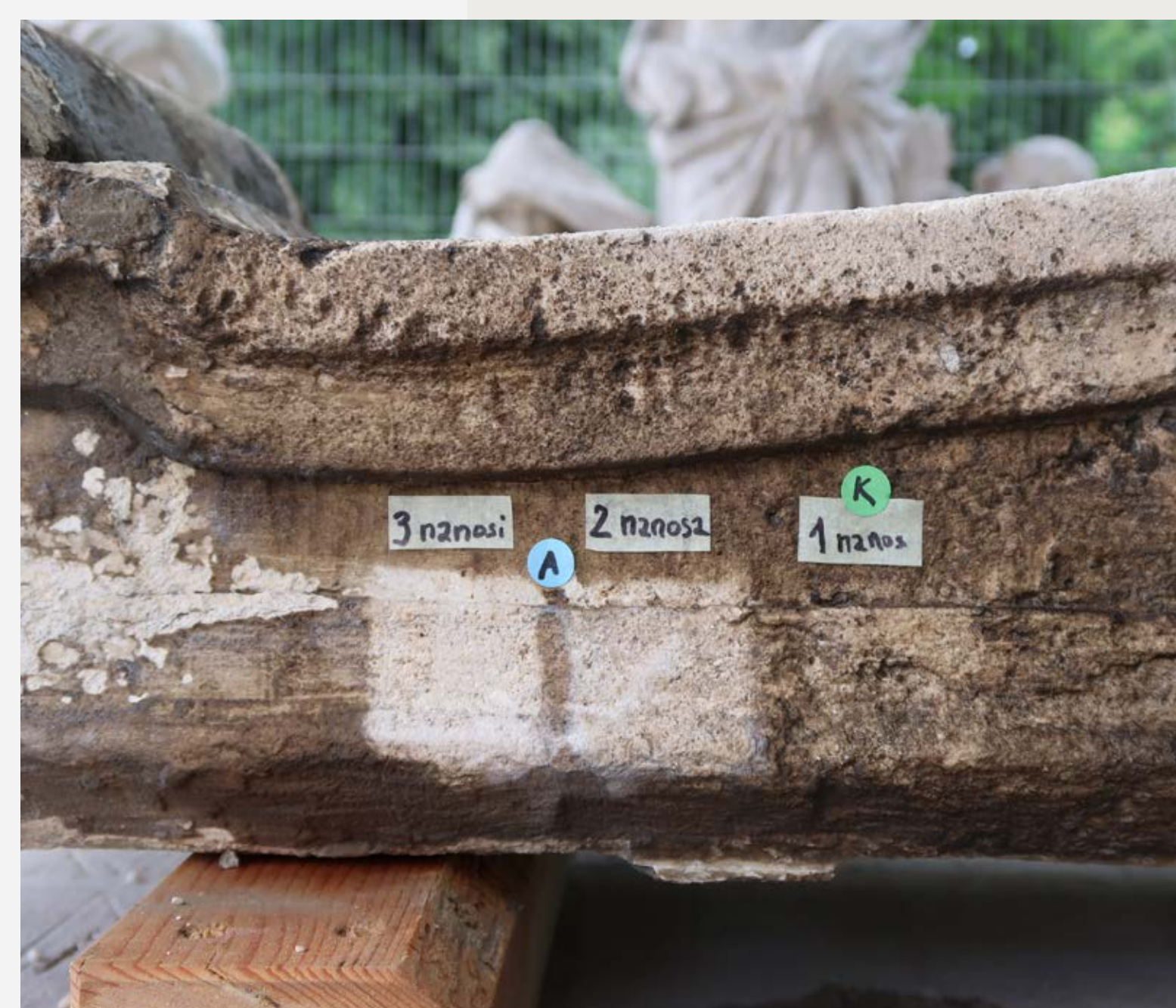
Slika 6: Preizkus čistilne učinkovitosti anionskih in kationskih smol na konzoli podstavka Marijinega znamenja, foto: arhiv ZVKDS RC
