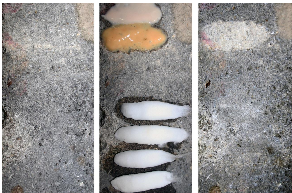
Odstranjanje temnih sekundarnih oblog s kamnite površine (stanje površine pred (levo), med (sredina) in po testiranju (desno).
