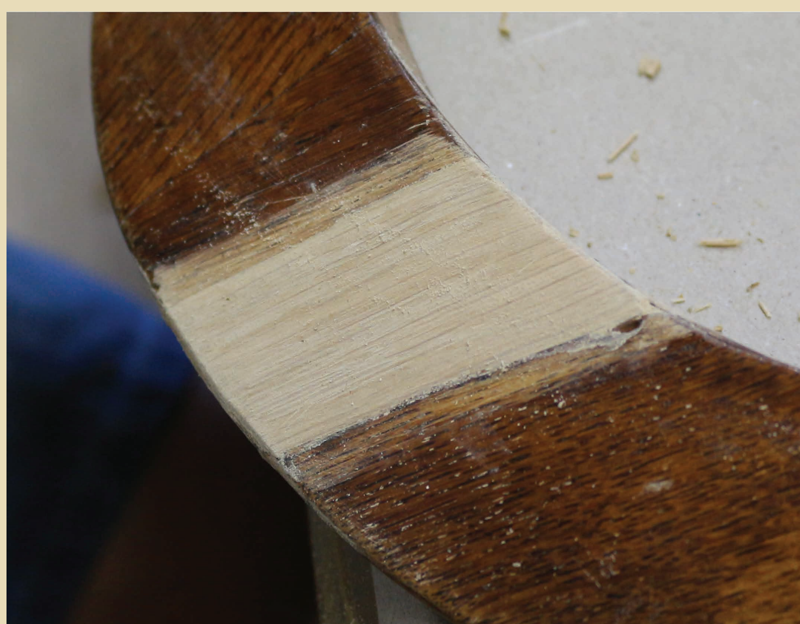
Dopolnjevanje površine s furnirjem
