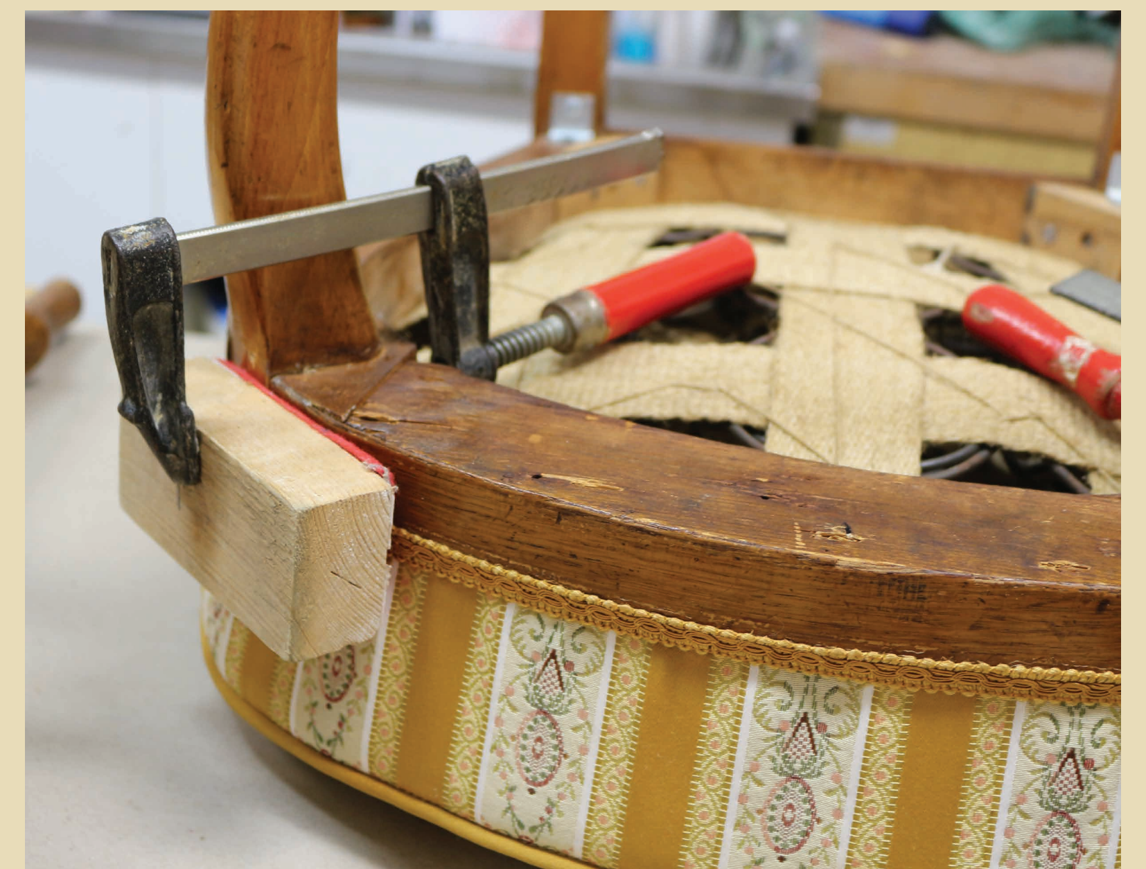
Ojačevanje razrahljanih spojev
