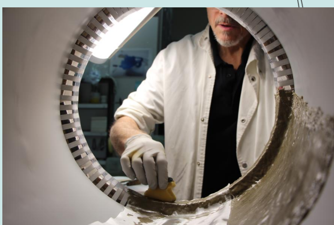
Nanos obarvanega epoksida na notranjo steno negativnega kalupa (foto: Matjaž Bizjak, NMS).
