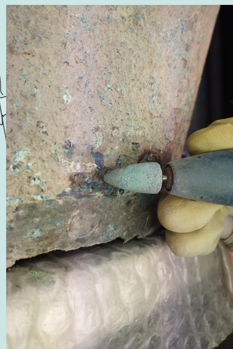
Nivelacija korozijske obloge na zunanji površini z brušenjem z mikromotorjem s korundnim nastavkom (foto: Matjaž Bizjak, NMS).
