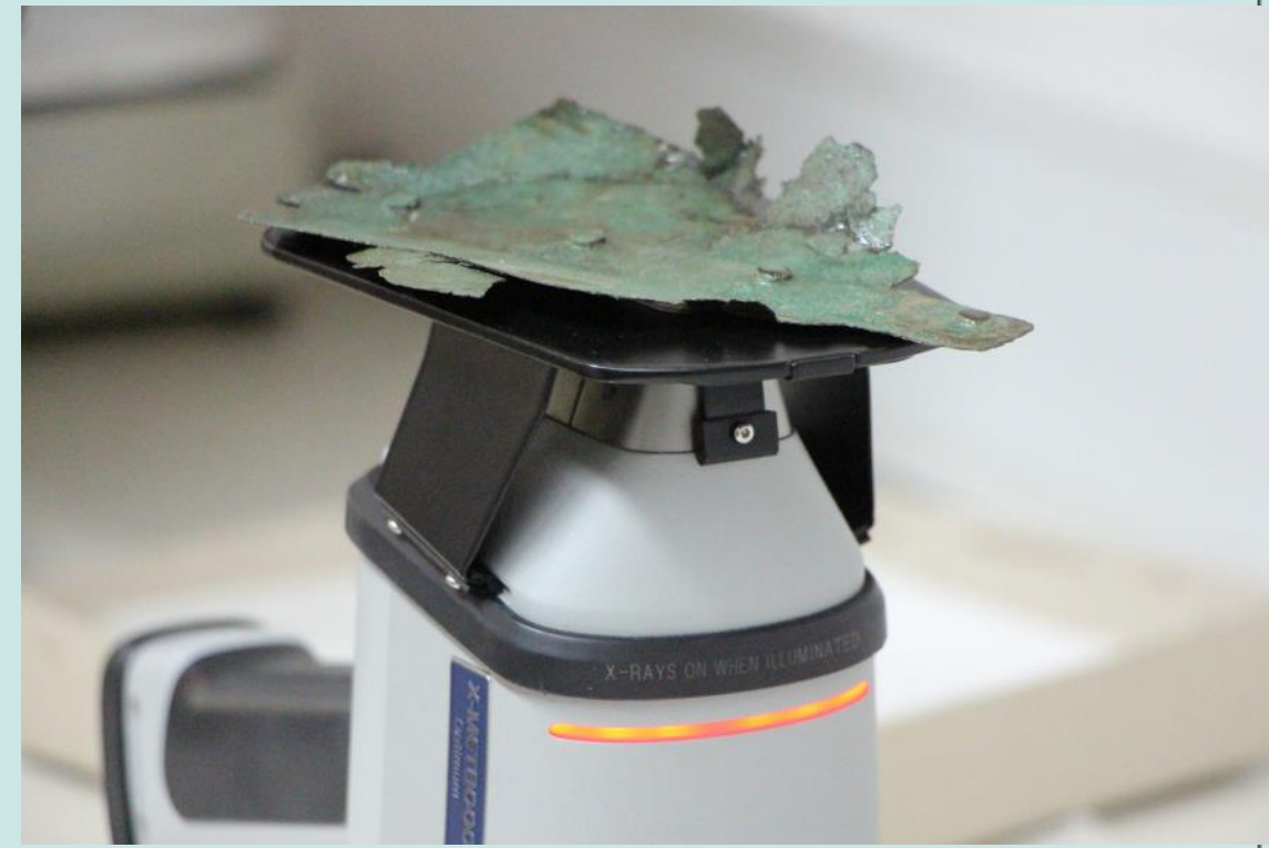
Analiziranje površine enega od večjih fragmentov ostenja posode s prenosnim instrumentom Hitachi X-MET 8000 (foto: Matjaž Bizjak).
