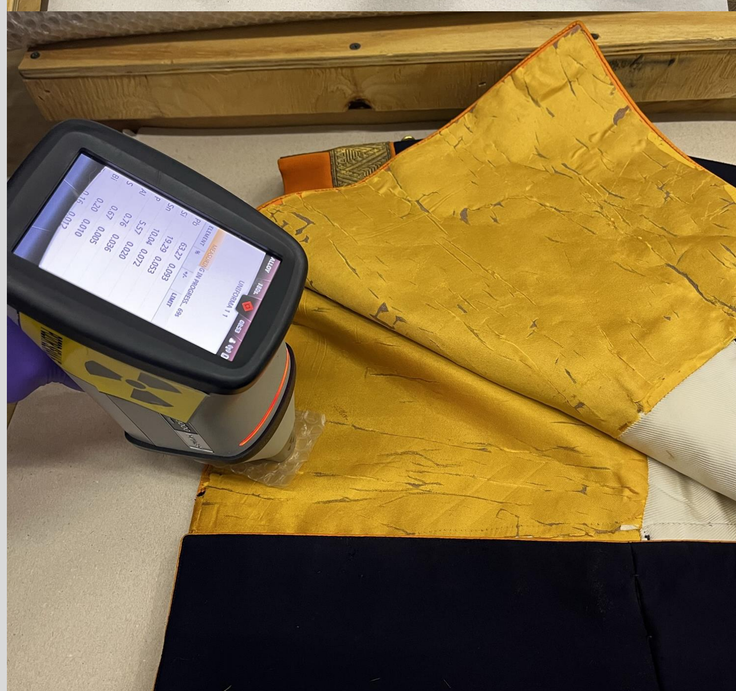
Poškodovana obtežena svila (podloga) in XRF analiza svile.
