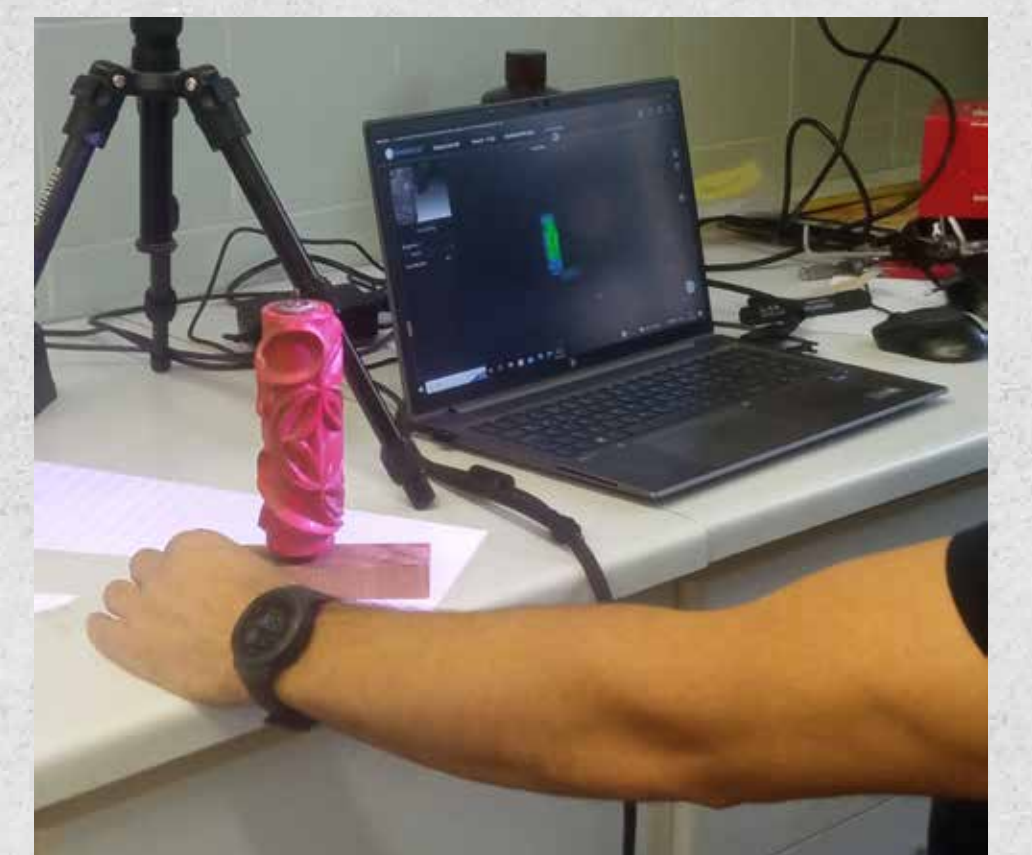
3D skeniranje krasilnega valjčka
