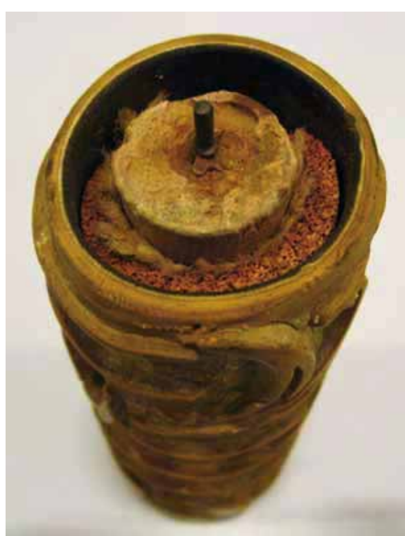
Sestava krasilnega valjčka (leseno jedro, penasto jedro, končni sloj iz naravne gume)
