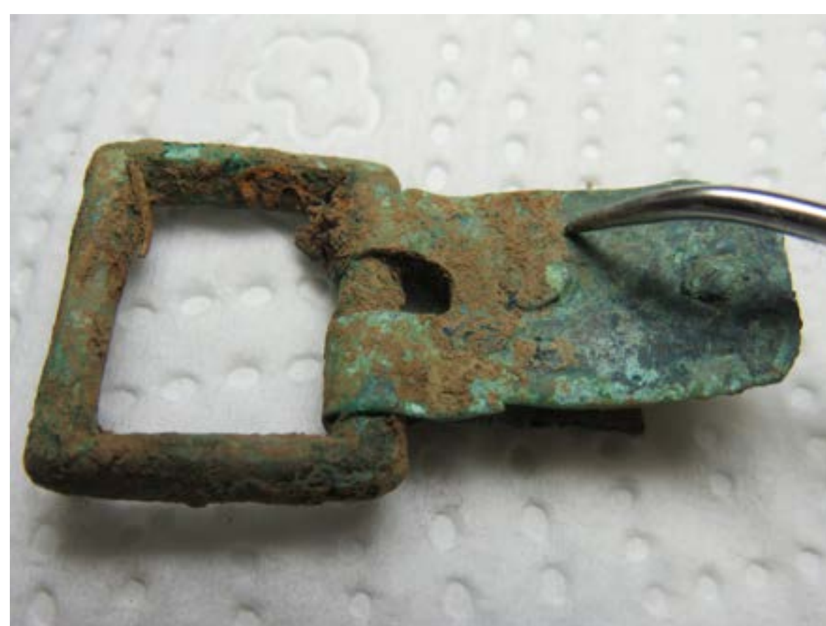
BRONASTA PASNA SPONA MED ČIŠČENJEM Z ULTRAZVOČNIM KLADIVCEM
