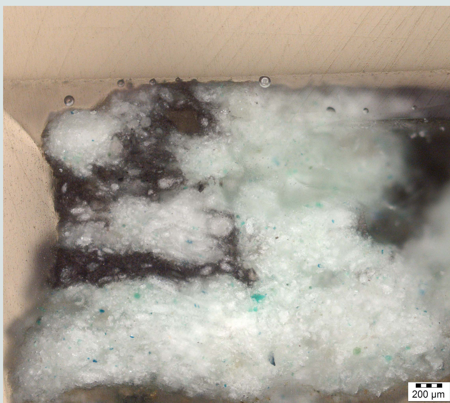
Slika 3: Mikrofotografija odvzetih vzorcev SMA11 2 (levo), kjer se vidi prepletenje štukmas različnih barv in SMA11 3 (desno), kjer so mase nanesele slojevito, spodaj se vidi tudi domnevni sloj podloge (foto: K. Kavkler).
