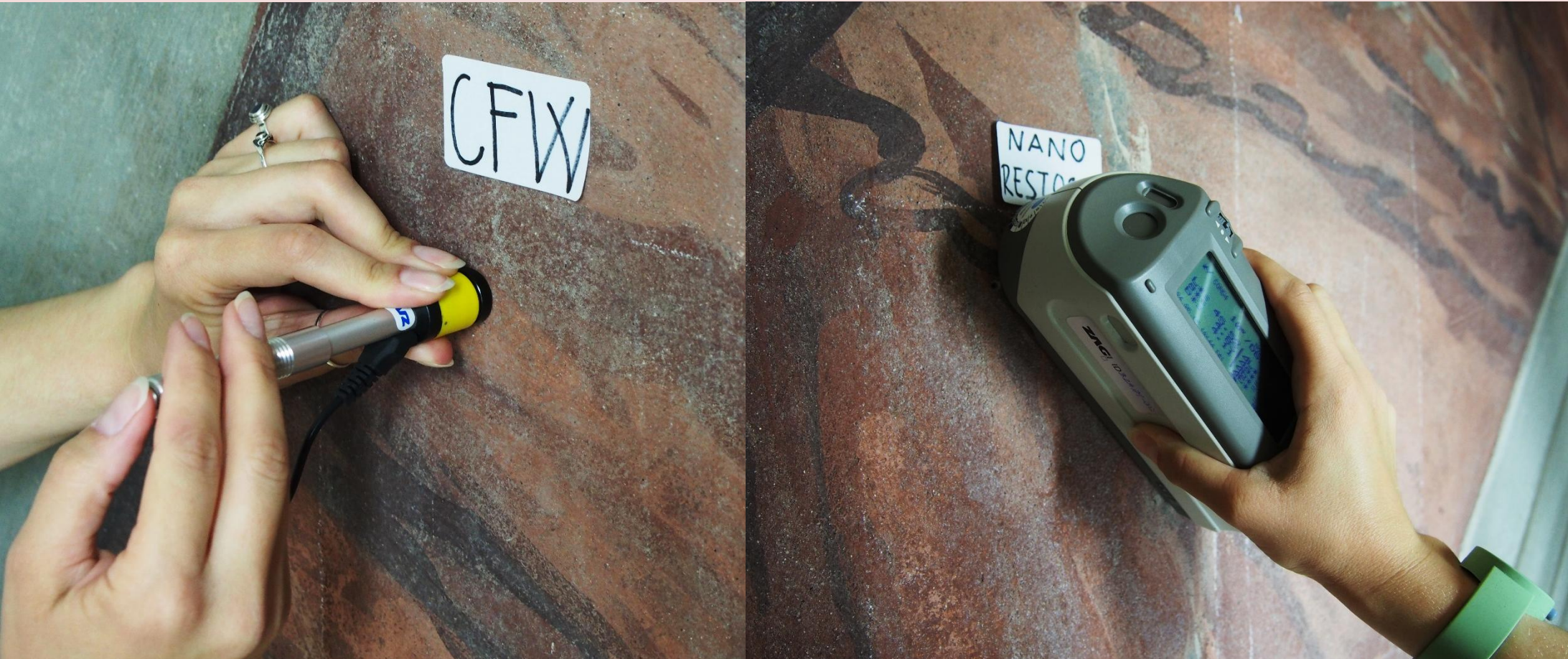
Slika 3: Merjenje mikrotrdote (levo) in barvnih vrednosti s spektrofotometrom (desno) (foto: Andreja Pondelak)
