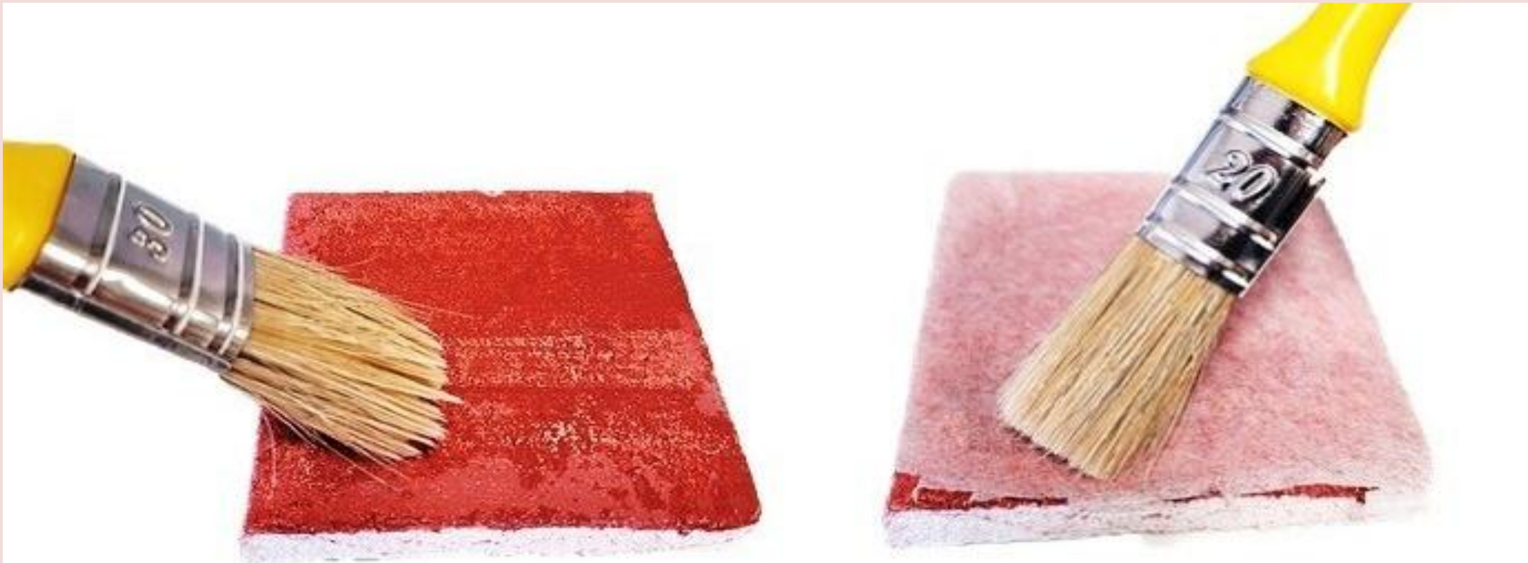
Slika 2: Primer nanosa utrjevalca (CFW) na modelni substrat (foto: Zala Žarkovič)
