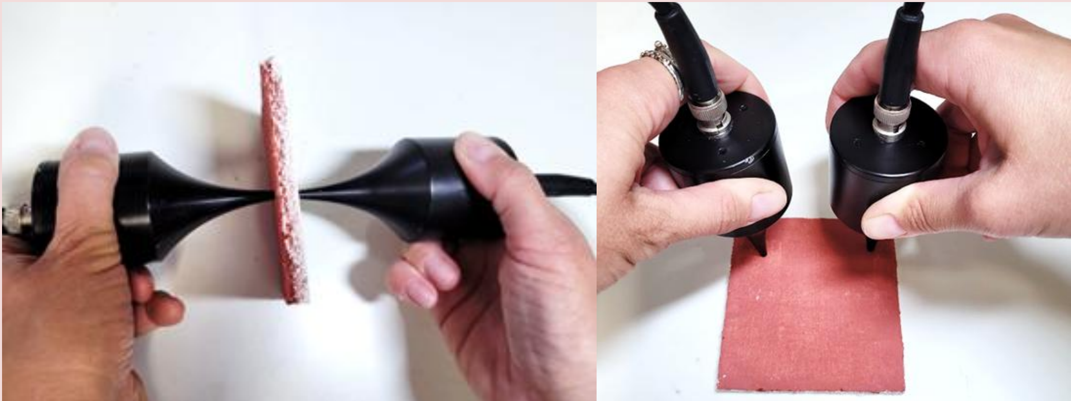
Slika 4: Ultrazvočne meritve: direktne (levo) in indirektne (desno) (foto: Zala Žarkovič)
